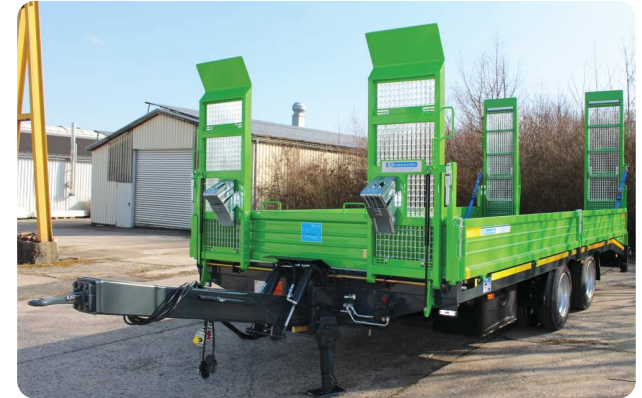
Mit Überfahrampen auf das Zugfahrzeug und hydraulisch höhenverstellbarem Zugbaum, Stirnwand und Eckpfosten steckbar
