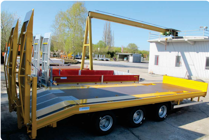
Tridem 25t GG, als Kombinationstieflader für den Transport von Abrollmulden und Baumaschinen
