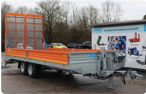
Feuerverzinktes Chassis u. Stirnwand, Bordwände u. Rampen lackiert im RAL-Ton nach Wahl, mit geschlossener Ladebordwand u. hydraulischen Rampenhebern
