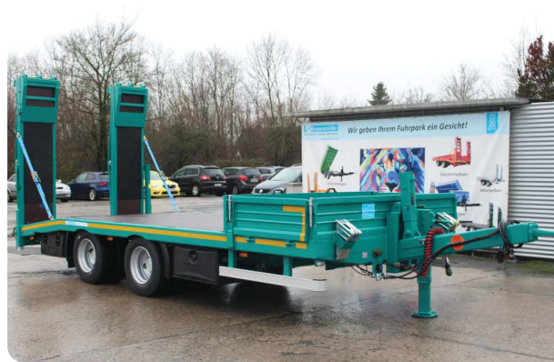
HEGE Belag in Rampen u. Auffahrschräge, Rampen verlängert u. geteilt, abgetrennte Ladefläche mit abnehmbaren Bordwänden
