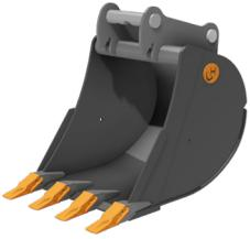
Boden und Seitenteile 5mm sowie Seitensicheln HB400, Seitenteile auf Boden gestellt, Messer HB400 150x16mm, geschweißtes Zahnsystem
