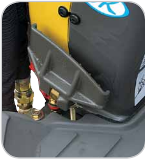
Ausklappbare Pedale (Pedal für den Zusatzkreis sowie das Pedal für das Ausleger-Schwenken)
