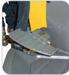
Ausklappbare Pedale (Pedal für den Zusatzkreis sowie das Pedal für das Ausleger-Schwenken)
