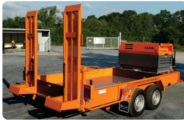
Minitieflader mit Kompressor aufgebaut und Alu-Riffelblechboden
