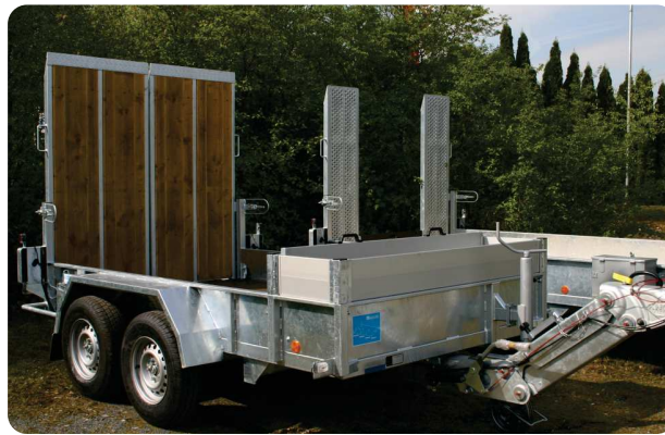
Minitieflader mit Abteil vorne und geschlossener Ladebordwand mit Holzbelag hinten
