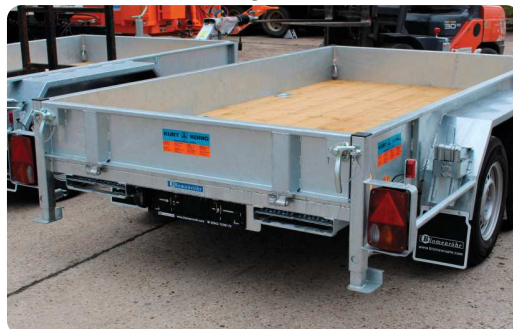
Rampen unter der Ladefläche eingeschoben, mit Heckklappe
