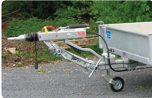
höhenverstellbare Zugdeichsel (bis 3150kg GG)
