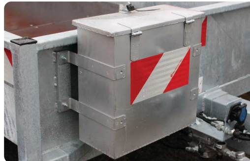
Werkzeugkiste aus Stahlblech und Warnmarkierung
