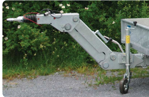
höhenverstellbare Zugdeichsel für Typ 441/3500
