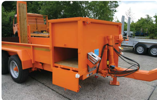
doppelter Staukasten mit Seitenklappen u. Deckel für die Beladung von oben
