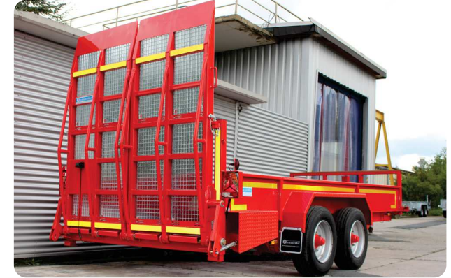
AWST 568/10500 mit geschlossener Ladebordwand mit Gitterrosten u. Ablagefläche für Baggerschaufel
