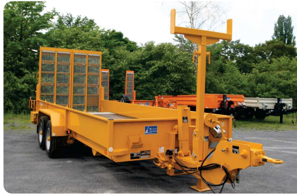
AWST 569/11900 mit Ablage für Fräsenladeband u. Schwenköse
