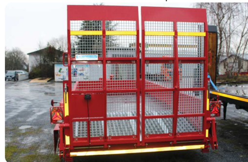
geschlossene Ladebordwand, Gleitschutzroste auf der Schräge
