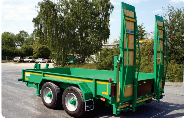
AWST 566/8900 mit Rampenfederhebwerk
