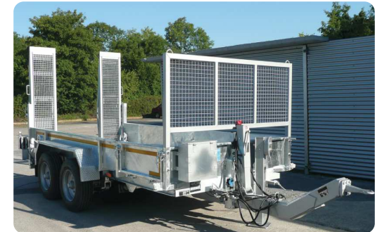
Werkzeugkiste an der Stirnwand, steckbare Stirnwanderhöhung, Seitenklappe
